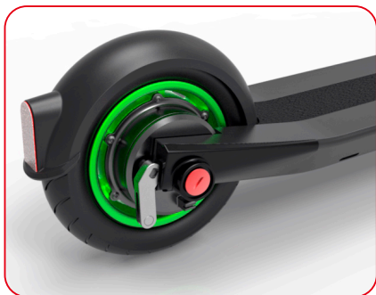
INNERE TROMMELBREMSE & AUTOMATISCHER AUSSCHALTER
